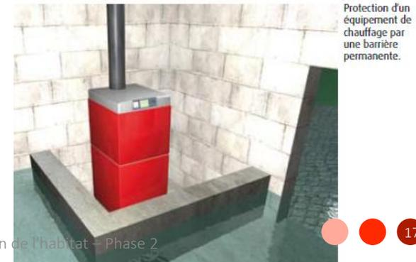
Protection d'un équipement de chauffage par une barrière permanente.
