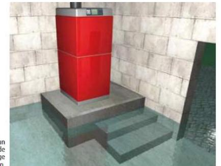
Protection d'un équipement de chauffage par surélévation.
